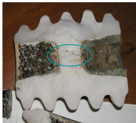
Характер повреждения фарфорового опорного изолятора токопровода генератора
